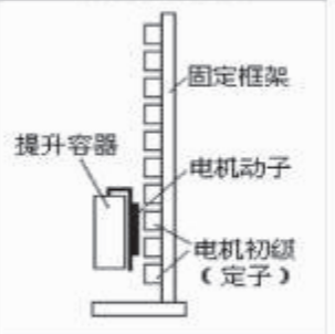
图1: 分段式永磁直线同步电动机垂直提升系统示意图
